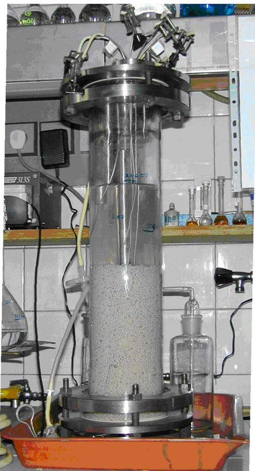
Obr. 1: Náplňový bioreaktor se siranovými kuličky a válečky.
