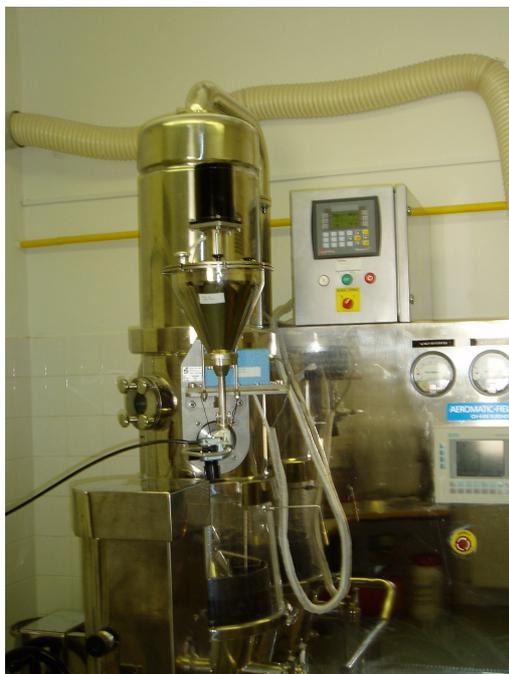
Rotoprocessor multifunkčního zařízení Aeromatic MP 1 s nainstalovaným práškovým dopravníkem
